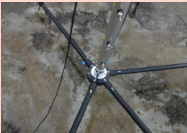
給電棒基部にスプレッターを差し込む。
