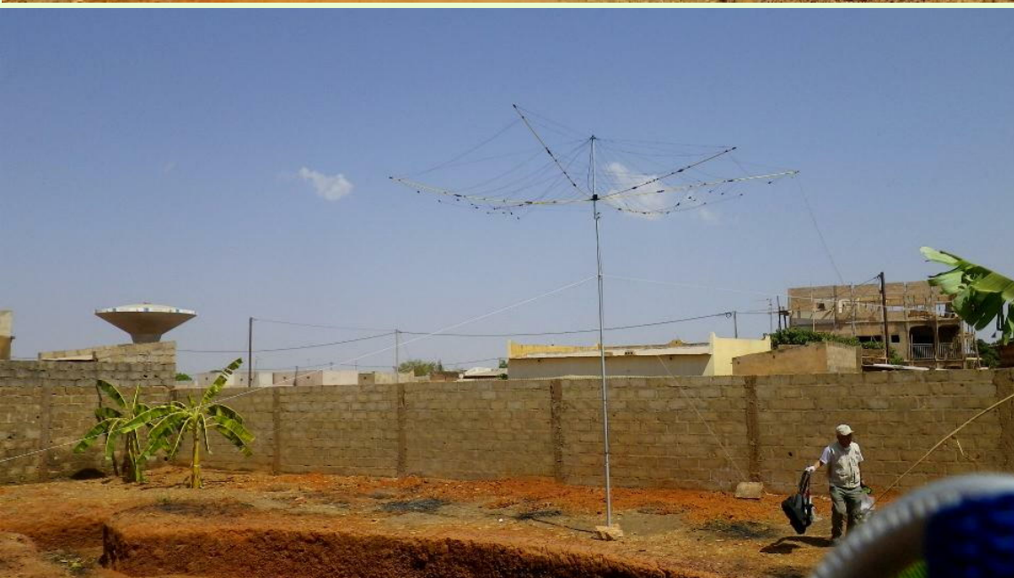
裏庭に設置したHEX BEAM (14,18,21,24,28,50用) 左奥はUFOではなく給水塔です
