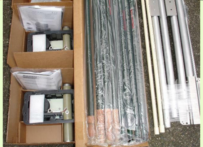
写真 10 梱包を解いたStepp IR ANT 梱包ケースの左側にエレメント長を調整するステップモーターとそのハウジングがみえる。モーターは各エレメントの基部にすわる
